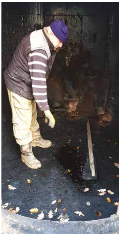
Obr. 11: Uvnitř ocelové pece – místo, kde uhlíř zakládá rošt. Zdroj foto AZK.
