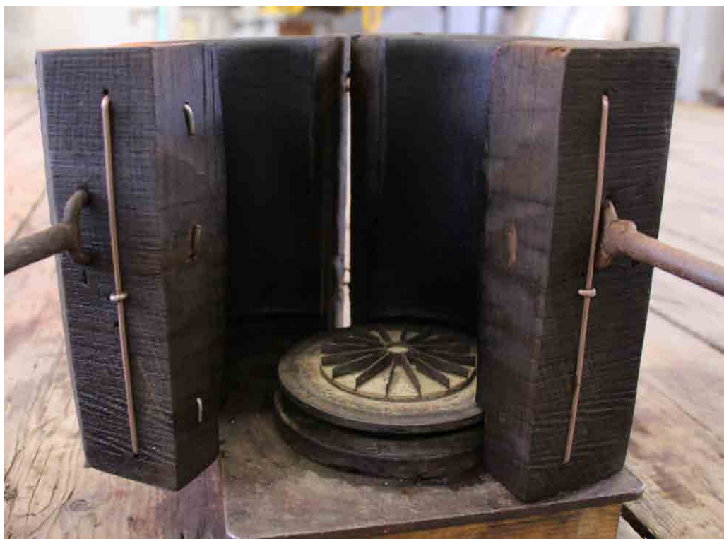
Obr. 4: Dřevěná sklářská forma s otáčivou ozdobnou růžicí (na dekor T92) – nástroj chráněný patentem č. 171951, foto F. Mucha, fotoarchív Muzea regionu Valašsko.
