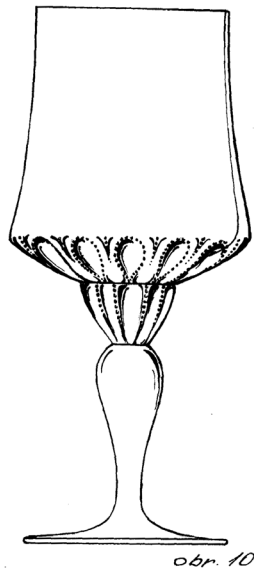
Obr. 10a-b: Ozdobné růžice pro tvarování dna a dolní části odlívek a pro zdobení spodní části kalicha a přechodu mezi kalichem a stonkem, příloha patentního spisu č. 171951. Zdroj: https://isdv.upv.cz
